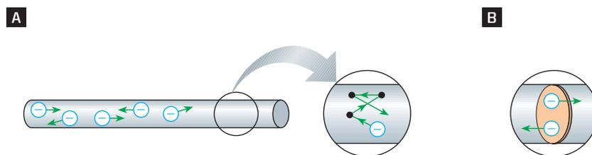
▲ **Figura 2.** (A) Num condutor metálico em equilíbrio eletrostático, o movimento dos elétrons livres é desordenado. Em destaque, a representação de um elétron livre em movimento desordenado. (B) O número de elétrons livres que atravessam a seção transversal do condutor em equilíbrio eletrostático, num certo intervalo de tempo, é igual nos dois sentidos.
