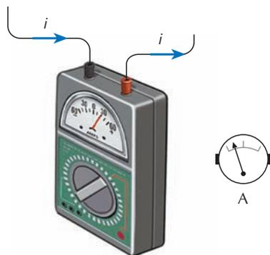
► **Figura 9.** Aparelho destinado a medir a intensidade de corrente. Ao lado dele temos um dos símbolos usados para representar um amperímetro no circuito.
