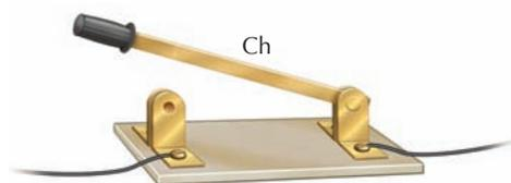
► **Figura 8.** Chave Ch, para fechar ou abrir um circuito elétrico.
