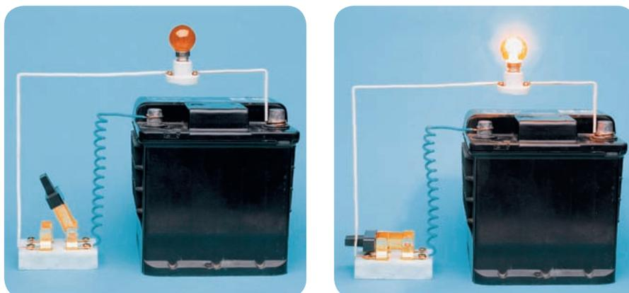
► A bateria e a lâmpada, ligadas por fios condutores, constituem um circuito elétrico. Ao fechar a chave (interruptor), há passagem de corrente elétrica e a lâmpada acende.
