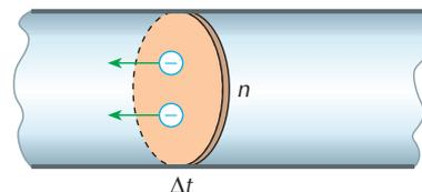
▲ **Figura 4.** No intervalo de tempo  $\Delta t$ ,  $n$  elétrons passam pela seção do condutor.
