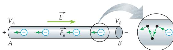
▲ **Figura 3.** Ligando o condutor ao gerador, há uma ddp  $V_A - V_B$  entre os terminais do condutor e o movimento dos elétrons é ordenado. Em destaque, a representação de um elétron livre avançando sob ação do campo elétrico.
